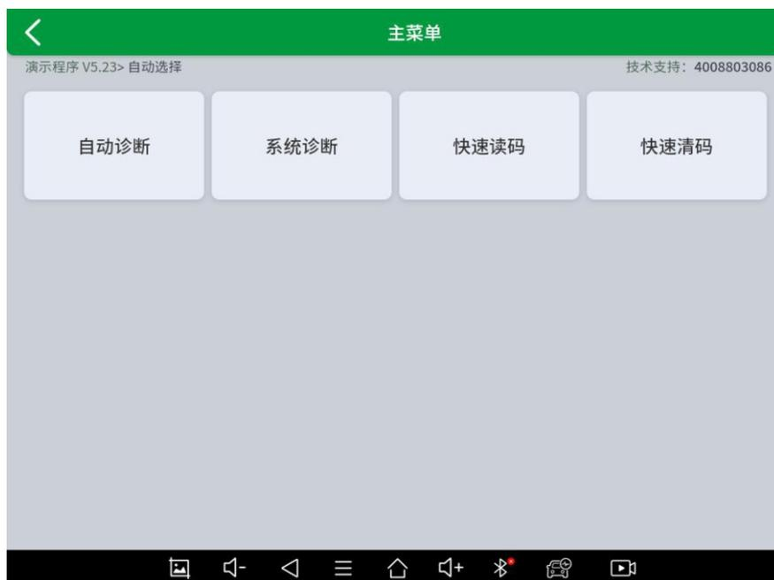
【自动诊断】选择此功能后，诊断平台会自动识别车身系统并自动进行诊断；
