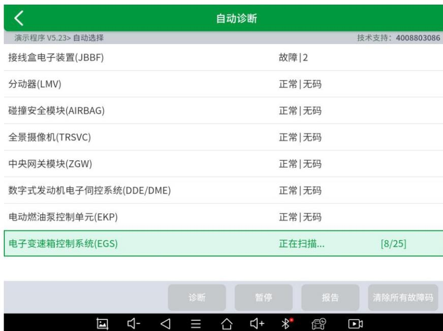
【系统诊断】此处，您可根据您所需要诊断的模块手动选择相应的系统
