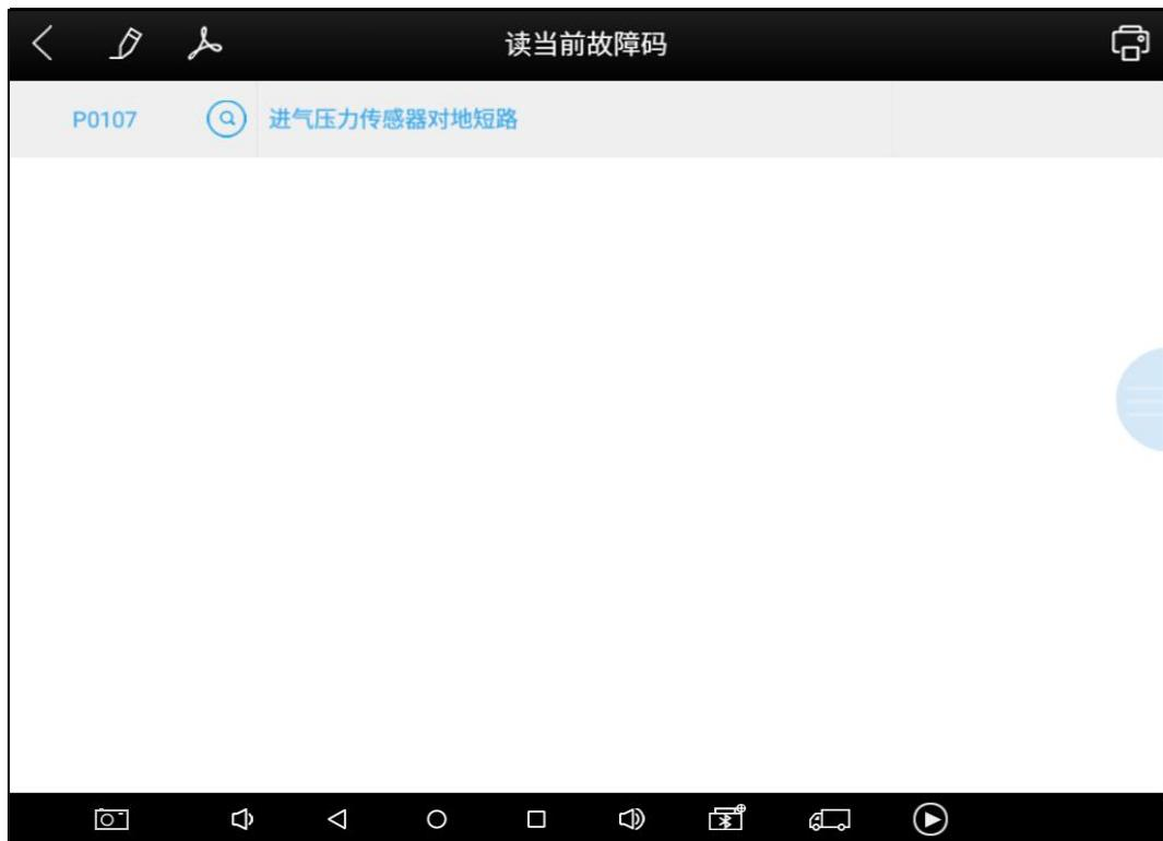
提示：对故障车进行检测时，如果显示系统正常或无故障码，则说明ECU中未存储相关故障码或某些故障现象不在ECU监控范围内，多属于机械故障，也可能是传感器在范围内出现信号偏差，这可在数据流功能中进行判断。
