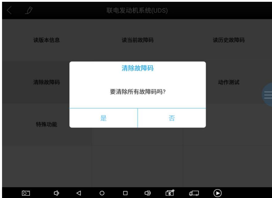
2、点击【是】确认清除故障码后，将显示故障码清除成功或故障码已经清除，通常清除故障码后需再读取故障码以确认故障码是否被清除。
